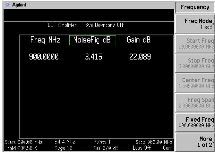
그림 1-7 미터 포맷으로 된 일반적인 고정 주파수 측정 결과.
